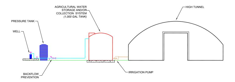
ADDITION OF STORAGE TANK ALLOWS A LOW-YIELDING WELL TO FURNISH WATER SUFFICIENT TO OPERATE A MICRO-SPRINKLER SYSTEM
